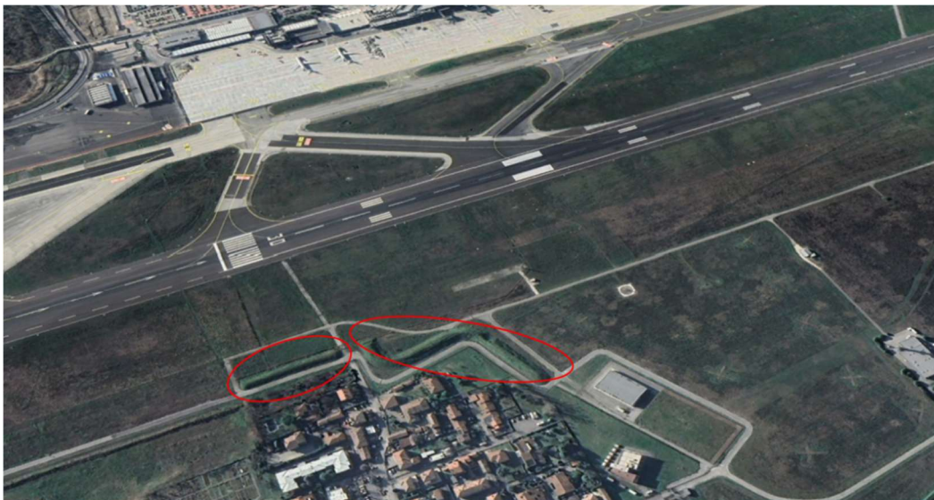
Figura 8: Barriera antirumore realizzata da Aeroporto Marconi di Bologna a difesa del centro abitato di Lippo
